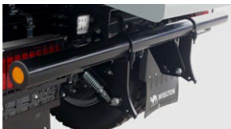
Tyłny zderzak - możliwe konfiguracje: składany lub stały przystosowany do adaptacji przyczepy.
