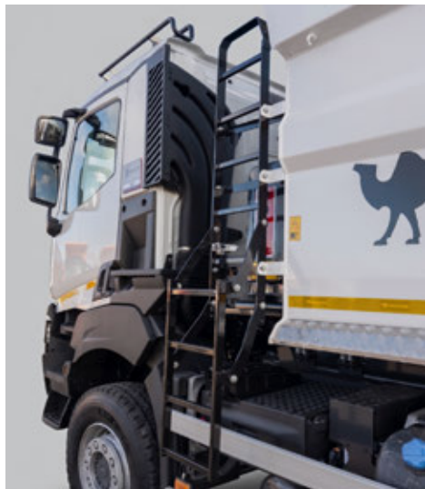
Rozkładana boczna drabinka ułatwiająca wejście do skrzyni.
