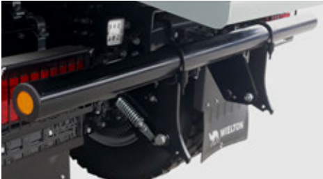
Tylny zderzak - możliwe konfiguracje: składany lub stały przystosowany przystosowany do adaptacji przyczepy.
