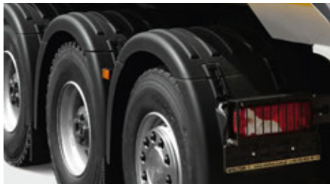
Możliwa konfiguracja błotników: stalowe lub plastikowe.
