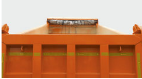
Plandeka zwijana na ścianie przedniej.
