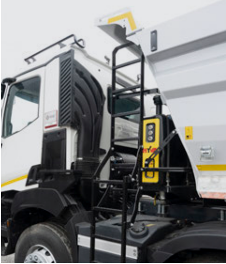
Rozkładana boczna drabinka ułatwiająca wejście do skrzyni.
