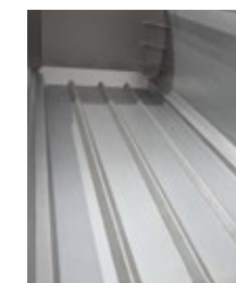
Wzmocnienia wzdłużne podłogi
