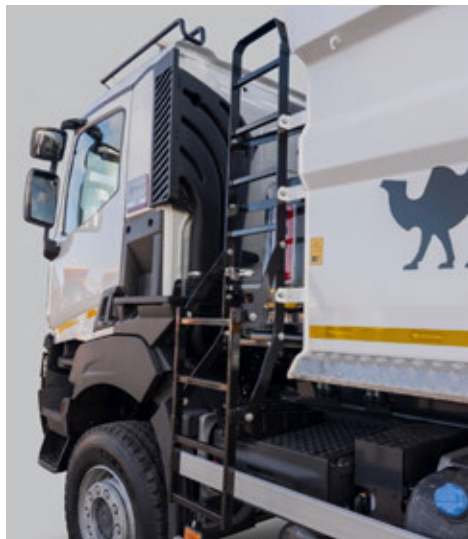
Rozkładana boczna drabinka ułatwiająca wejście do skrzyni.
