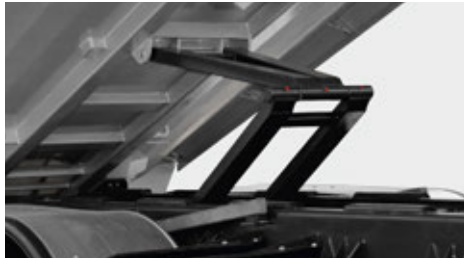
Stabilizator skrzyni zapewniający większe bezpieczeństwo przy wyładunkach.
