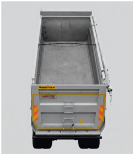
Rozszerzająca się ku tyłowi skrzynia ładunkowa ograniczająca blokowanie się materiałów w skrzyni.
