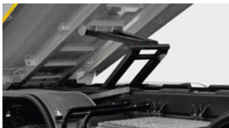
Stabilizator nożycowy poprawia bezpieczeństwo podczas załadunku.
