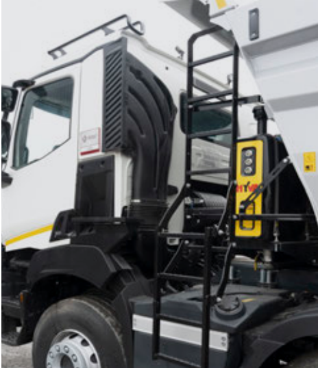
Rozkładana boczna drabinka ułatwiająca wejście do skrzyni.
