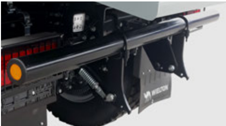
Tylny zderzak, możliwe konfiguracje: składany lub stały przystosowany do adaptacji przyczepy.
